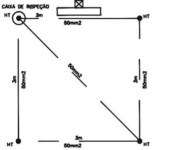
**DETALHE DA MALHA DE ATERRAMENTO SEM ESCALA**
