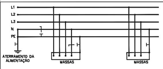
**ESQUEMA TN-S DE ATERRAMENTO/SISTEMA TRIFÁSICO SEM ESCALA**
