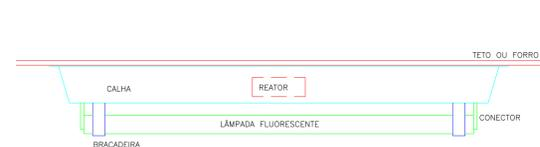
DETALHE DE FIXAÇÃO DE CALHA PARA LÂMPADAS FLUORESCENTE SEM ESCALA
