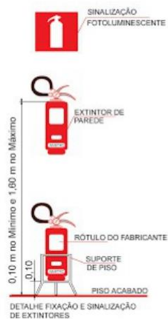
Figura 4: Detalhamento da altura da sinalização de emergência
